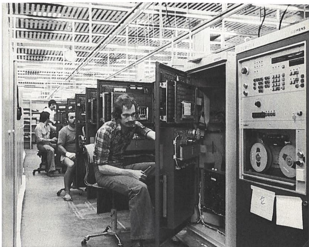
Overzicht van de serieproductie van Siemens Sinumerik Systeem 7 in de fabriek in Erlangen.
